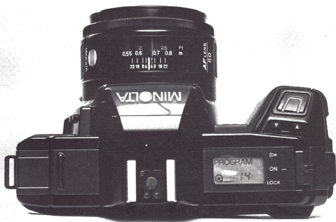
Til højre ses Minolta 5000's forenkede LCD-panel, hvor man bl.a. får information om funktionsmåde (auto/manuel), filmtransport, billednummer, ISO-indstilling, batteritilstand og selvdløserfunktion.
