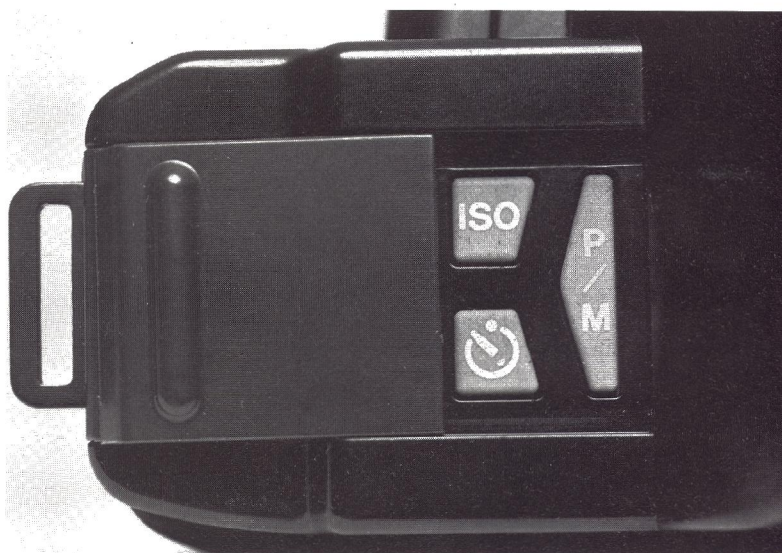
Under skydedækslet til venstre for søgehuset findes knapper for ISO-indstilling, selvdløser og manuel eksponering.
